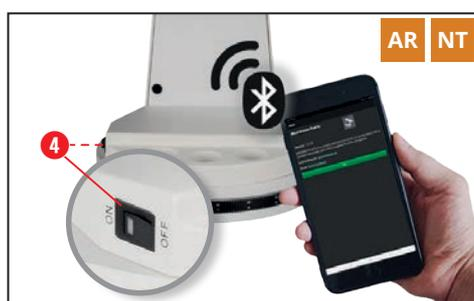
1. Déplacez l'interrupteur marche/arrêt (4) sur la position [ON]. Attendez environ 30 secondes pour que Bluetooth® soit activé sur le télescope.
