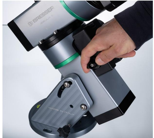
Drehen Sie die RA-Achse um 180°
