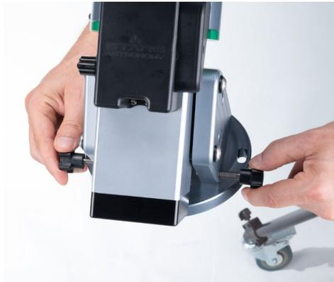
Die Langlöcher der Montierungsbasis müssen mit den auf dem Stativ installierten Azimut-Einstellstiften zusammenpassen
