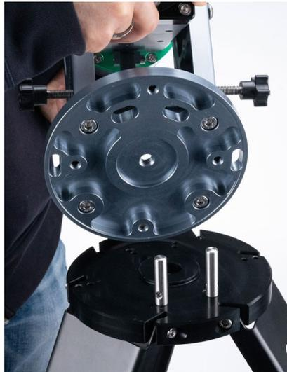
Setzen Sie die Montierung auf das Stativ und ziehen Sie die beiden Azimut-Einstellknöpfe an den entsprechenden Stiften fest
