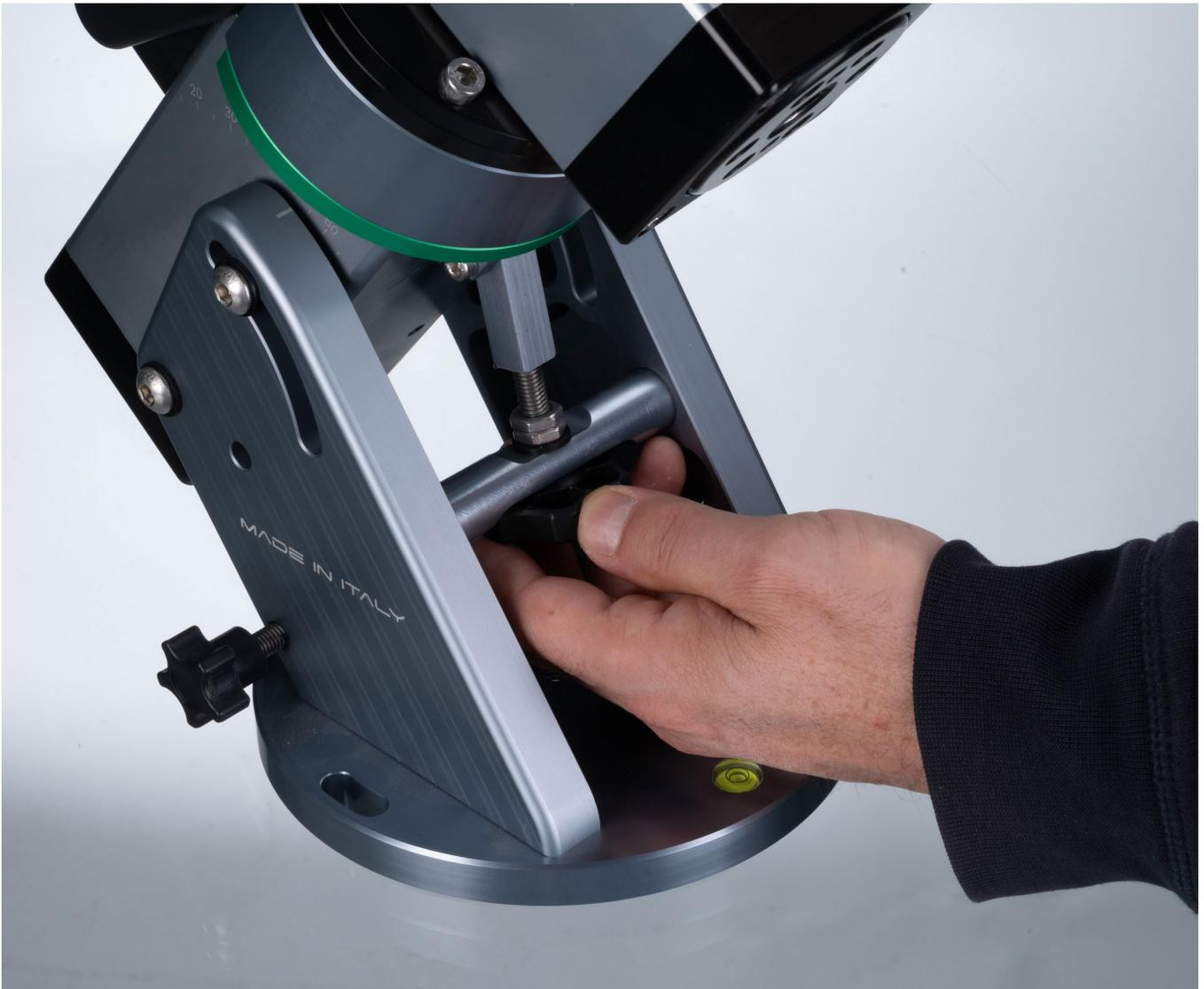
HINWEIS: Die Feineinstellung des Breitengrades muss bei gelösten Schrauben der vier seitlichen Befestigungshalterungen vorgenommen werden. Sobald der Breitengrad eingestellt ist, müssen diese wieder festgezogen werden.
